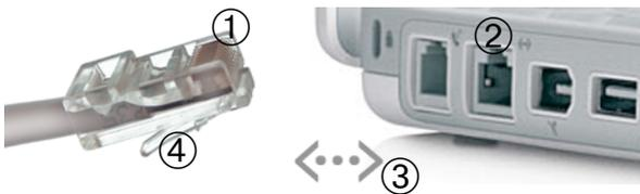
Geht es darum, lediglich zwei Computer miteinander zu verbinden, benötigen wir nur ein *gedrehtes Netzwerk-Kabel*, auch *Cross-* oder *Crossover-Kabel* genannt. Die beiden Stecker ① verbinden wir jeweils mit der Netzwerk-Buchse eines Computers ②, die oft durch das Symbol ③ gekennzeichnet ist. Sie rasten mit einem Klick-Geräusch ein, zum Herausnehmen muss der Hebel ④ zum Stecker gedrückt werden. Das ist alles.
